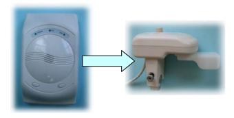
直接由警報器背部之排線端子(#10、#11)提供信號以驅動機械閥
